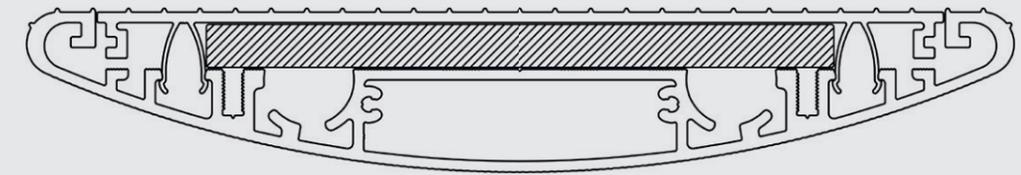
Stufen – Beim Begehen leise, rutschfest und mit einer harten, langlebigen Oberfläche durch Eloxieren des Aluminiums. Es ist eine Stufenbreite von bis zu 1.200 mm möglich und die große Stufentiefe (280 mm) bietet optimalen Gehkomfort.
